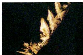
Figura 7. : Toma microscópica ( Luz polarizada) de microcristales que crecen al borde de una gota de agua "corriente" no tratada magnéticamente
