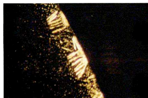
Figura 8. : Toma microscópica ( Luz polarizada) de microcristales que se agrupan al borde de una gota de agua tratada magnéticamente
