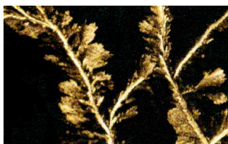
Figura 9 : Toma microscópica ( Luz polarizada) de microcristales de Carbonato de calcio formados en agua destilada tratada magnéticamente /Ref 7/
